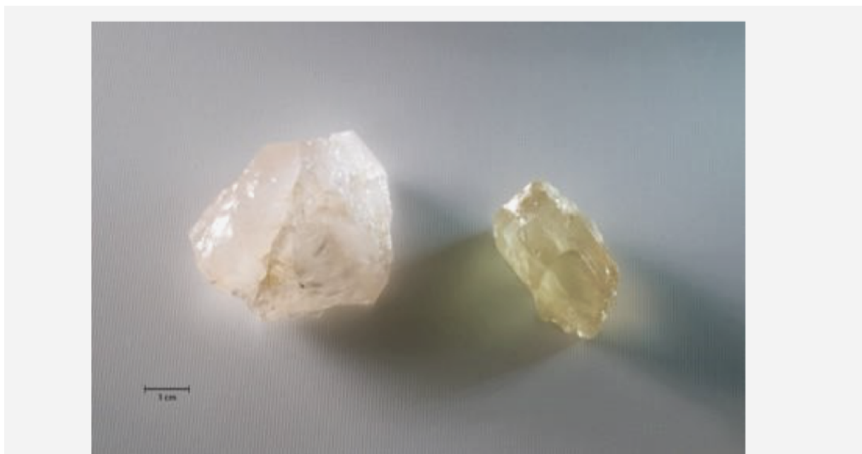
Foto 6. Amostras de quartzo irradiadas a 600kGy (esq.) e 720kGy (dir.) com tratamento térmico a 475°C.
